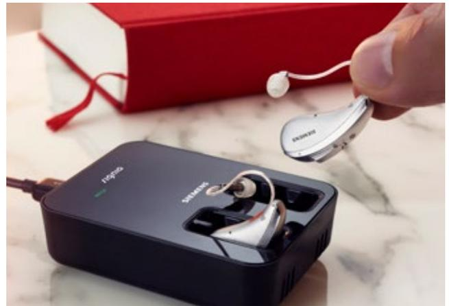
Cellion, das erste Hörgerät weltweit mit wiederaufladbarem Lithium-Ionen-Akku und drahtloser Induktionstechnologie. Das Gerät wurde von Sivantos entwickelt, dem weltweit erfahrensten Marktführer in der Branche der wiederaufladbaren Hörgeräte, und bietet Benutzern eine **unbegrenzte drahtlose Übertragung** für bis zu zwei Tage mit einer einzigen Aufladung.
